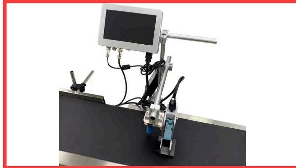
El equipo loteador marca Dikai DE-1 funciona con un cabezal de impresión con cartuchos de tinta HP de tecnología Thermal Inkjet, está construido en aluminio de grado industrial, con una electrónica robusta y eficiente, con tintas de alta calidad especiales para imprimir en plásticos, metales, cajas de corrugado, vidrio, etc.
