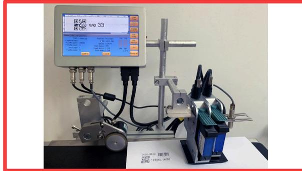
El equipo loteador marca Dikai DE-2 funciona con dos cabezales de impresión con cartuchos de tinta HP de tecnología Thermal Inkjet, está construido en aluminio de grado industrial, con una electrónica robusta y eficiente, con tintas de alta calidad especiales para imprimir en plásticos, metales, cajas de corrugado, vidrio, etc.
