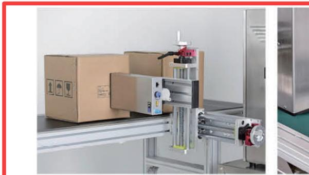
Gracias a su sistema de control de tinta, el equipo puede imprimir con los cabezales en cualquier dirección.
