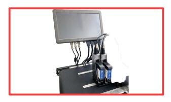
El equipo loteador marca Dikai EP-2 funciona con dos cabezales de impresión con cartuchos de tinta HP de tecnología Thermal Inkjet, está construido en aluminio de grado industrial, con una electrónica robusta y eficiente, con tintas de alta calidad especiales para imprimir en plásticos, metáles, cajas de corrugado, vidrio, etc.
